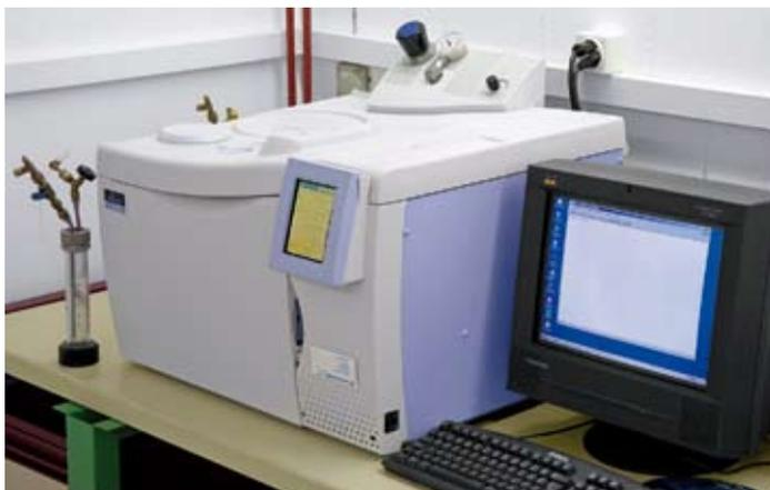
Der Gas-Chromatograph liefert in 20 Minuten die Zusammensetzung des angelieferten Kältemittels, geeignet für alle synthetischen Kältemittel
