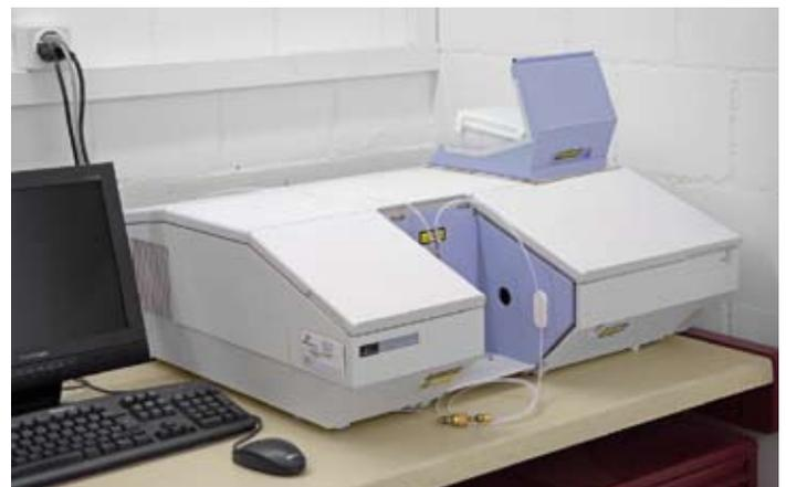
Infrarotspektrometer für eine Schnellanalyse in einem vorgegebenen Toleranzband
