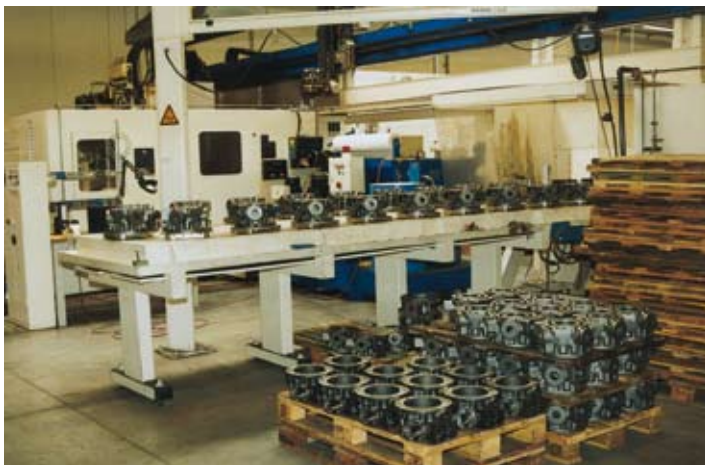
Vollautomatisches Gehäuse-Bearbeitungszentrum (l.) für die Trennhaubenverdichter-Fertigung sowie ein Eindruck von der piksauberen Montagehalle (r.)
