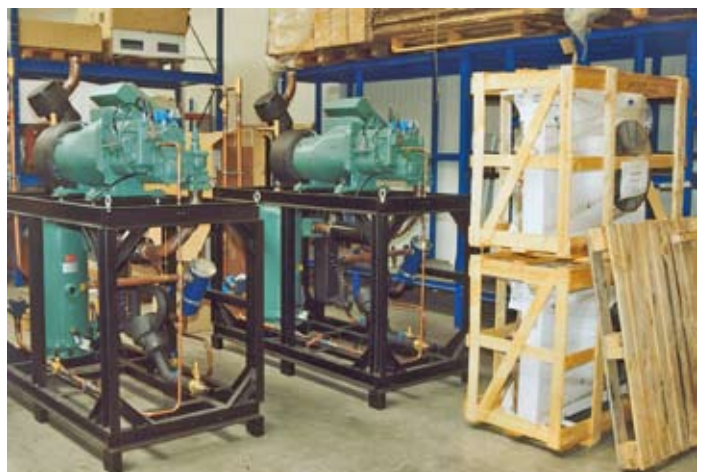
2 Bitzer Schraubenverdichtersätze mit den Typen HSN 8571-125 Y für Schockfroster-Anwendungen
