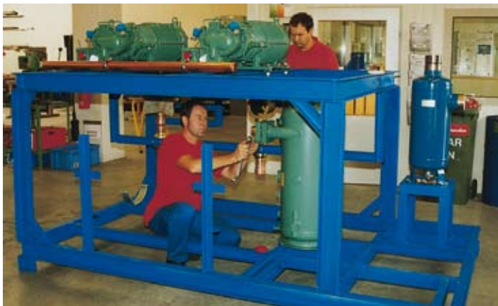
TK-Verbundanlagenbau mit Bitzer-Kompaktschraubenverdichter HSN 7471 für einen Fleischereibetrieb (l), Cu-Rohre schneiden und biegen (r)
