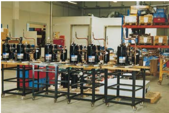
Kleinserienfertigung von Verdichtersätzen mit Digital-Scrolls von Copeland für luftgekühlte Kaltwassersätze
