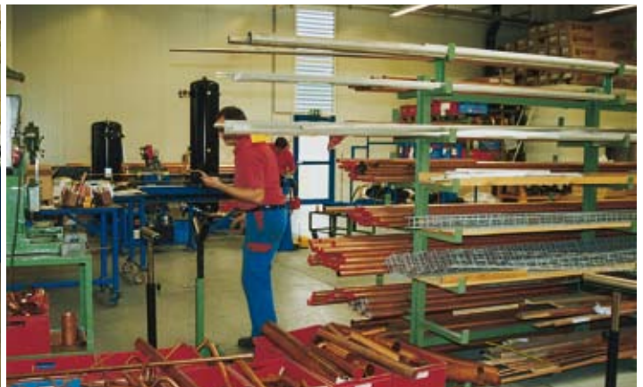
TK-Verbundanlagenbau mit Bitzer-Kompaktschraubenverdichter HSN 7471 für einen Fleischereibetrieb (l), Cu-Rohre schneiden und biegen (r)
