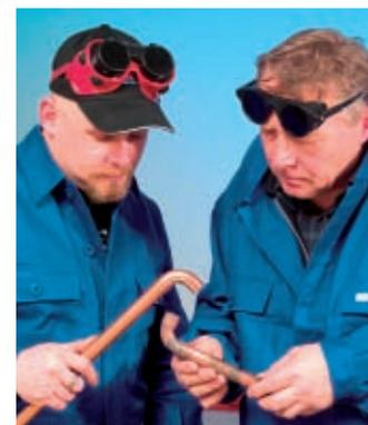
Hartlöten von Kupferrohr: Das Übungswerkstück wird vorbereitet und mit der Lötprobe verglichen
