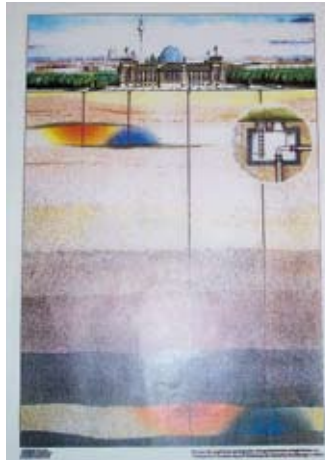
Thermografische Darstellung der unterirdischen Wärmespeicher für den Reichstag
