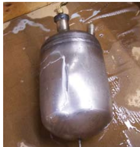
Begutachtung der Schweißnähte bei ESK-Schulze in Velten bei Berlin
