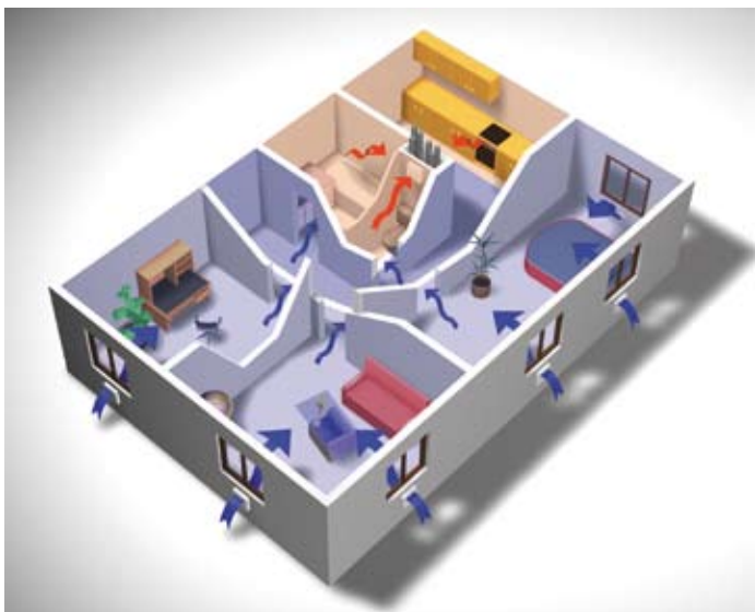
Bild 1 Auch die Lüftung von fensterlosen Räumen ist kontrollierte Wohnungslüftung und wird im Neuentwurf der DIN 1946 Teil 6 behandelt
