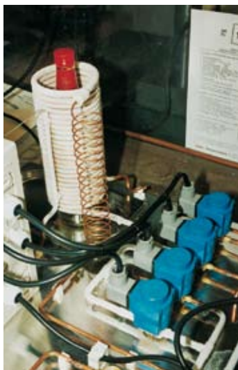
Als Wettbewerbsarbeit war eine Kälteanlage mit Wärmepumpenschaltung zur Flaschenkühlung/-erwärmung zu erstellen. Für die Anfertigung einschließlich Erstellung eines RI-Fließbildes sowie eines Stromlaufplans hatten die Teilnehmer auch individuelle Freiräume, die sie nutzten; z.B. bei der Behandlung des Kapillarrohres als Expansions-einrichtung. Links die Ausführung des Bundesmeisters Matthias Scheck
