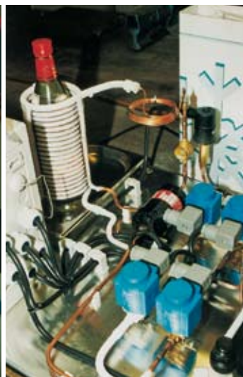
Als Wettbewerbsarbeit war eine Kälteanlage mit Wärmepumpenschaltung zur Flaschenkühlung/-erwärmung zu erstellen. Für die Anfertigung einschließlich Erstellung eines RI-Fließbildes sowie eines Stromlaufplans hatten die Teilnehmer auch individuelle Freiräume, die sie nutzten; z.B. bei der Behandlung des Kapillarrohres als Expansions-einrichtung. Links die Ausführung des Bundesmeisters Matthias Scheck
