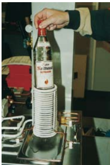
Als Wettbewerbsarbeit war eine Kälteanlage mit Wärmepumpenschaltung zur Flaschenkühlung/-erwärmung zu erstellen. Für die Anfertigung einschließlich Erstellung eines RI-Fließbildes sowie eines Stromlaufplans hatten die Teilnehmer auch individuelle Freiräume, die sie nutzten; z.B. bei der Behandlung des Kapillarrohres als Expansions-einrichtung. Links die Ausführung des Bundesmeisters Matthias Scheck
