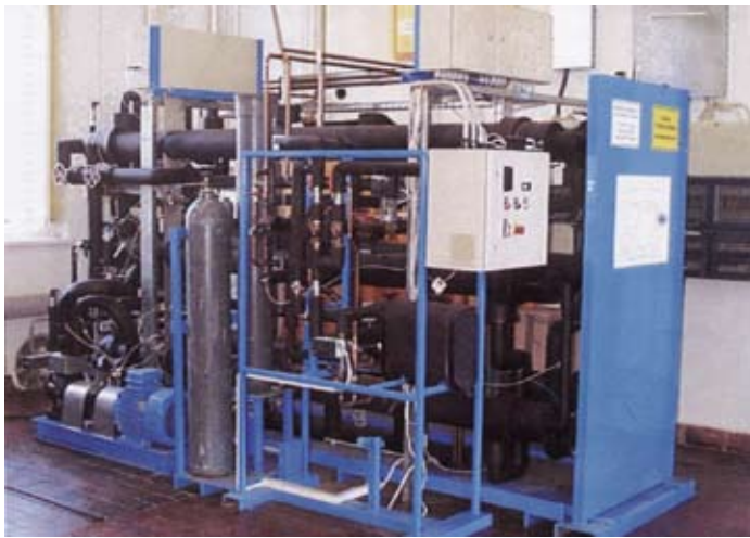
Prüfstand zur Erprobung der dreistufigen direkt wirkenden Kolbenexpansionsmaschine für CO 2 der TU Dresden
