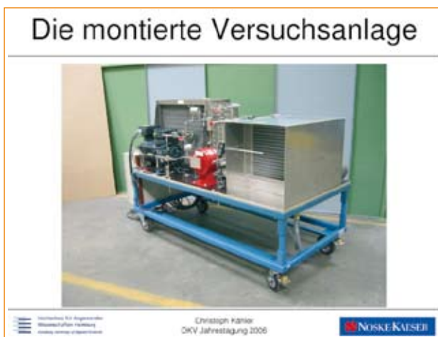
Christoph Kähler hatte in seiner Diplomarbeit an der Hochschule für Angewandte Wissenschaften Hamburg eine Versuchsanlage für die Fahrzeugklimatisierung mit CO 2 als Kältemittel konstruiert, aufgebaut und erste Messergebnisse ermittelt
