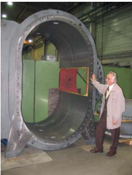
Der Berichterstatter am bearbeiteten Gehäuse des weltgrößten Drehkolbengebläses
