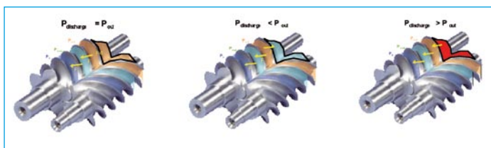
Bild 3 Einfluss des Verdichtungsendrucks ( P_{discharge} ) von Schraubenverdichtern auf den Arbeitseinsatz
