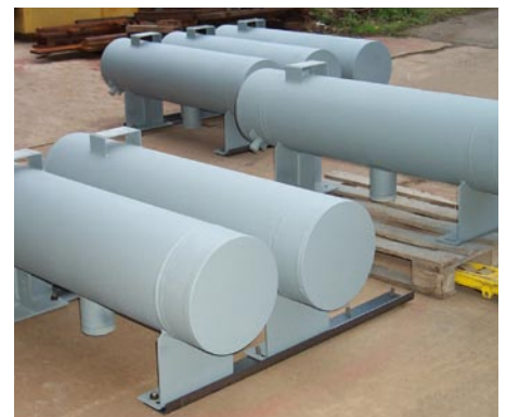
Bild 7 Ringkanal-Wärmeübertrager vor der Auslieferung beim Hersteller
