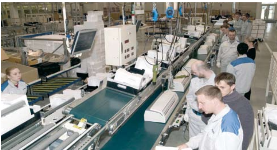
Fertigungsstraße F 1 – Inneneinheiten. Es gibt zwei F-Straßen für die Fertigung der Inneneinheiten. Als letzte und totale Kontrolle der Qualität wird jede Stunde eine Einheit herausgenommen und kontrolliert
