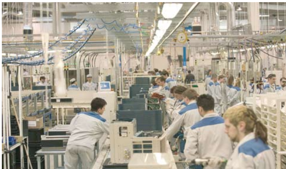
Fertigungsstraße R 1 – hier werden Außeneinheiten mit zwei unterschiedlichen Kompressortypen und 3 Typen Wärmeaustauscher montiert; eine Einheit wird in 45 Minuten hergestellt
