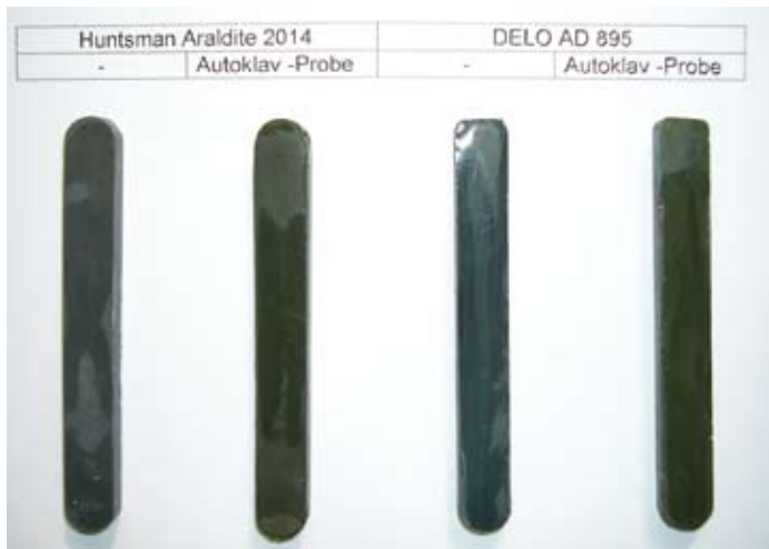
Bild 14 Klebstoff-Substratproben (10x80x5mm) für Kühlmittelalterung – links Klebstoff EP1, rechts Klebstoff EP2
