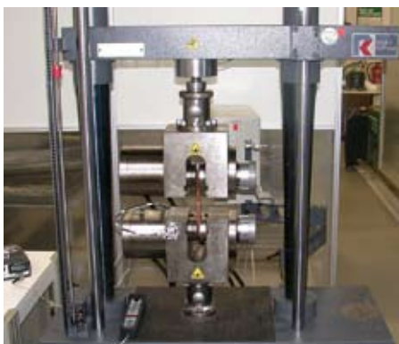
Bild 12 Prüfeinrichtung: Universalzug/-druckprüfmaschine; Nennzugkraft: 100 kN
