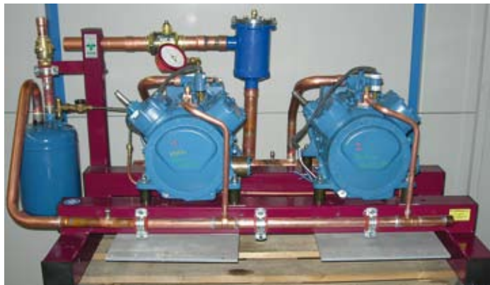
Bild 17 Verdichtereinheit mit mehrheitlich geklebten Rohrverbindungen
