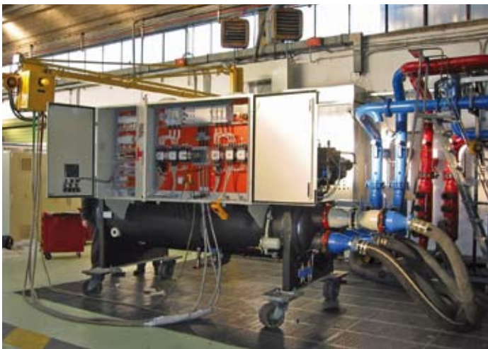
Abnahme eines Turbowasserkühlsatzes auf dem Prüfstand von McQuay
