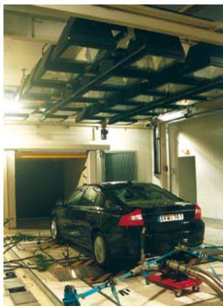
Für Klimawindkanal- und Abgasmessungen befindet sich hier ein Pkw der Marke Volvo auf dem Rollenprüfstand, oben an der Decke sichtbar die Solaranlage, die ein volles Sonnenlichtspektrum ermöglicht. Im angrenzenden Kontrollraum werden alle Messungen am Bildschirm überwacht und registriert
