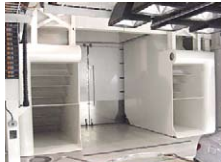
Für die Einbringung der Fahrzeuge in den Windkanal ist die Luftumlenkung und Rückführung geteilt und lässt sich nach beiden Seiten verschieben
