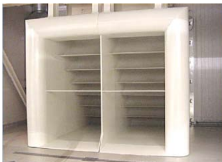
Für die Einbringung der Fahrzeuge in den Windkanal ist die Luftumlenkung und Rückführung geteilt und lässt sich nach beiden Seiten verschieben
