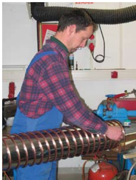
Ein spezieller Verdampfer entsteht unter den geschickten Händen eines Mitarbeiters
