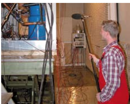
Jens Weyerhorst bei der Schallmessung als wichtiger Bestandteil der Eurovent-Zertifizierung
