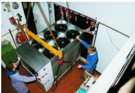
Techniker des KWT beim Einbringen eines Prüflings in die Prüfkammer
