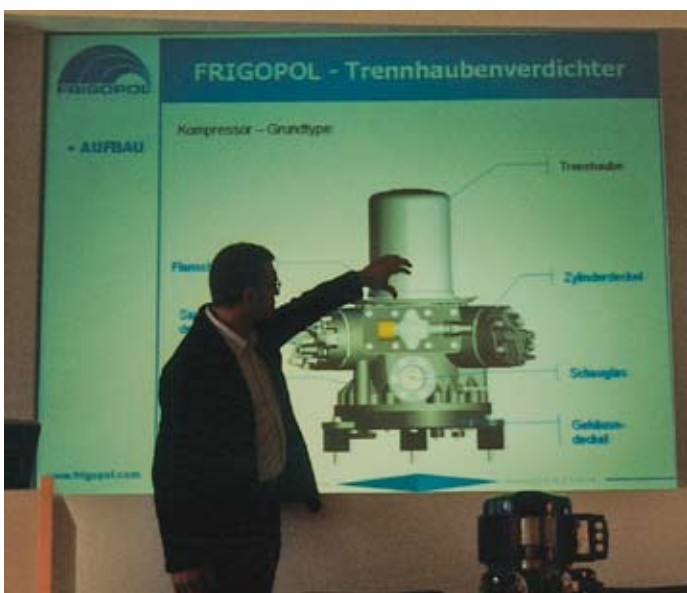
Das Grundprinzip des Frigopol-Trennhautverdichters: Infolge des aufgesetzten Stators ist der Kältemittelkreislauf immer von der elektrischen Motorwicklung getrennt
