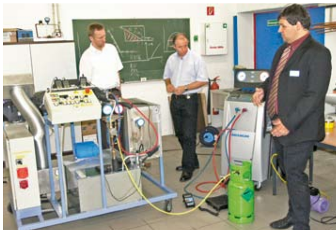
Ebenfalls zum TWK gehört eine Prüfstelle für Leistungs- und Betriebsuntersuchungen an allen Komponenten eines üblichen Kältemittelkreislaufs von Kompressionskältemaschinen
