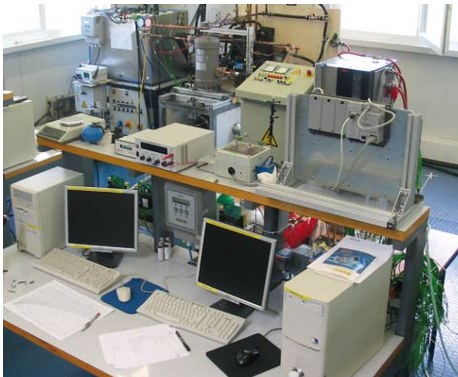
Verdichterprüfstand im TWK mit der Mess- und Auswertetechnik im Vordergrund
