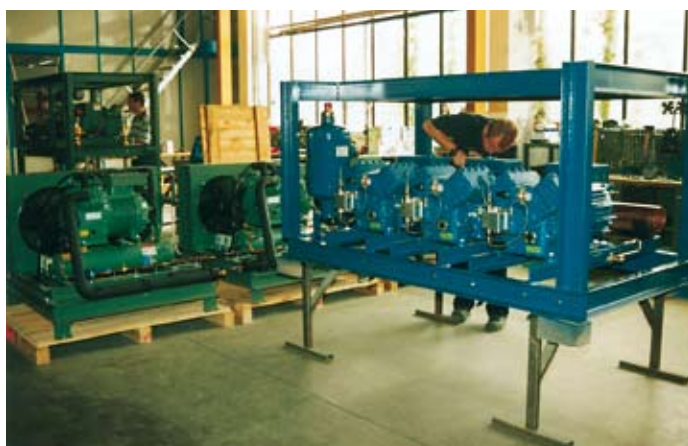
Die Farbe der Kälte ist Blau: Kältesatz-Montage mit Verdichtern von Bock
