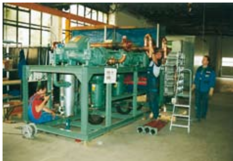
Fertigmontage von Verbundanlagen mit Bitzer-Schraubenverdichtern in unterschiedlichen Leistungsbereichen am 5. Juli 2007 zum Zeitpunkt der Jubiläumsfeier in der neuen Fertigungshalle
