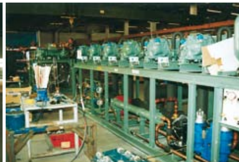
Fertigmontage von Verbundanlagen mit Bitzer-Schraubenverdichtern in unterschiedlichen Leistungsbereichen am 5. Juli 2007 zum Zeitpunkt der Jubiläumsfeier in der neuen Fertigungshalle
