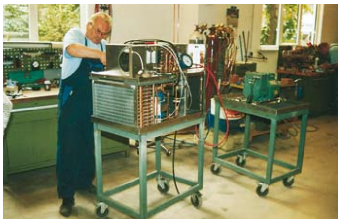
Die Montage von Kleinkältesätzen wie die Führerstandsklimatisierung für das Bahnklima wurde in die Produktionshalle 3 verlagert
