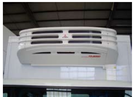
Mitsubishi-Transportkühlanlage TDJ600 mit einer Kälteleistung von ca. 7300W bei 0 °C und ca. 3700W bei –20 °C
