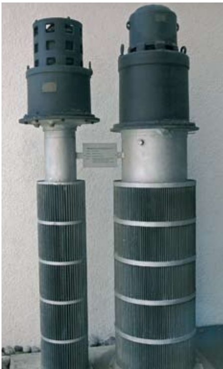
Kältemaschinen für die Kühlung von Luft, Fabrikat Escher Wyss, Typ Autofrigor Jahrgang 1920–1925, Kältemittel Dimethyläther [O(CH_3)_2] . Aufbau: Kurzschlussläufermotor, Verdichter mit schwingenden Zylindern, Doppelmantel-Verflüssiger, Schwimmerventil, Doppelrohrkörper-Verdampfer
